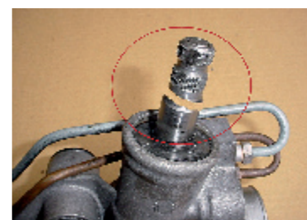
Károsodott vagy törött kormánymű
