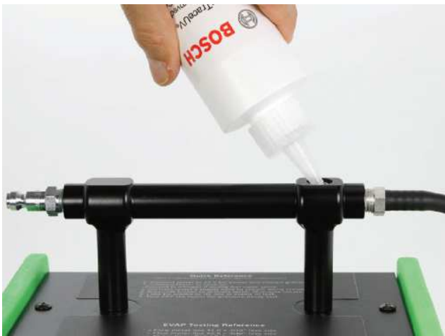
5. ábra: Az UltraTraceUV® füstkeltő oldat betöltése
