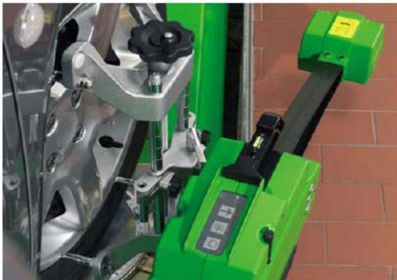
20. ábra: A mérőfejek beállítása
