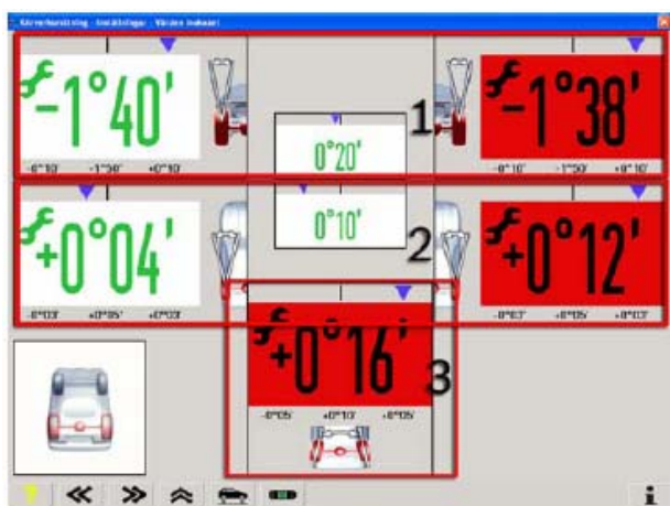
26. ábra: Hátsó tengely mért értékek
