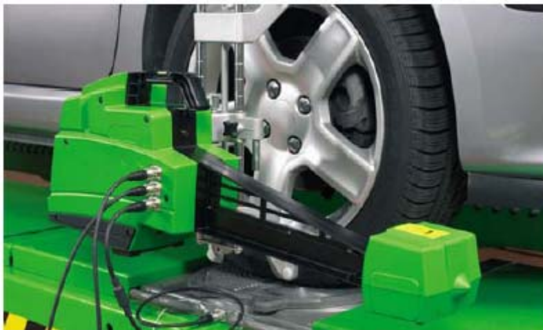
18. ábra: Az első mérőfejek pozicionálása
