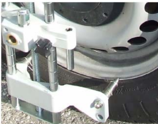
15. ábra: A felni peremhez történő csatlakoztatás
